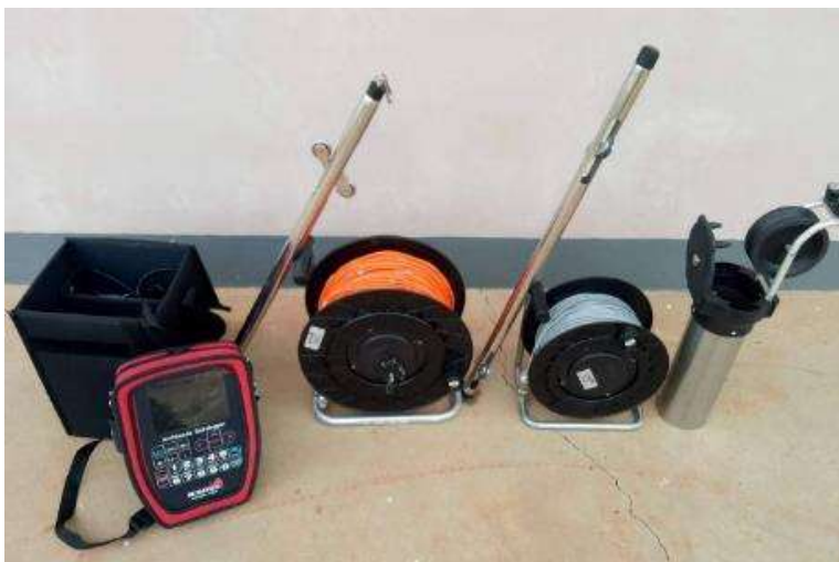
รูปที่ 3.7-10 อุปกรณ์มาตรวัดการเคลื่อนตัวในแนวราบ (Inclinometer) และท่อรางที่ใช้ติดตั้งในหลุมเจาะ (Inclinometer Access Tube)
